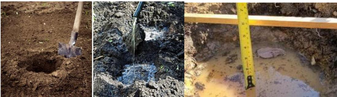
Imagen 6: Capacidad de drenaje. Fuente: Growit Buildit. (s.f.). Garden soil drainage test – Percolation. Recuperado de <https://growitbuildit.com/garden-soil-drainage-test-percolation>
